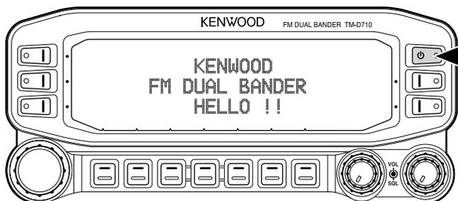
Appuyez à nouveau sur le commutateur [⏻] pour mettre l'émetteur-récepteur hors tension.
