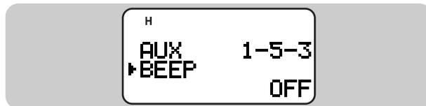
À l'élément de menu 1-5-3, vous pouvez aussi sélectionner "KEY" et "KEY+NEW DATA". Ces réglages sont décrits dans les sections traitant du système "APRS" (pages 63 et 77).
