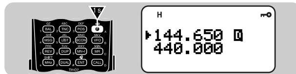
Il est possible d'utiliser la commande d'Accord ou les touches [UP]/ [DWN] lorsque l'émetteur-récepteur est verrouillé. Accédez à l'élément de menu 1-5-4 (TUNE ENABLE) pour activer cette fonction (ON).
